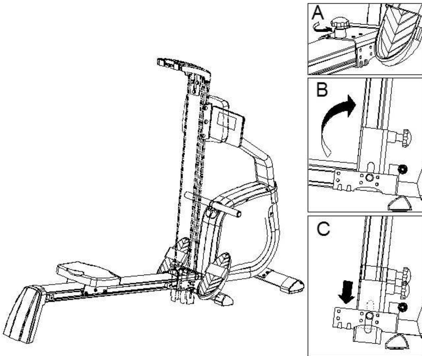
Ослабьте гайку, потяните направляющую каретки и затем, можете поднять её вверх и зафиксировать, надавив на неё сверху вниз.
